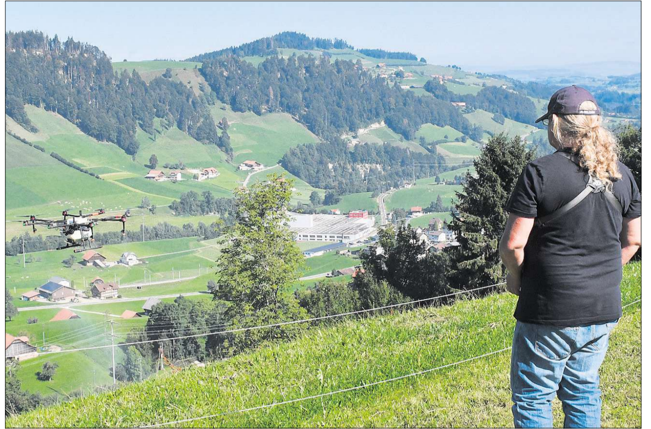
Jens Adank steuert die Drohne (am linken Bildrand) über die Weide. Sie fliegt zirka zweieinhalb Meter über dem Boden und sprüht aus einem Tank das Blacken-Herbizid Asulam aus.
