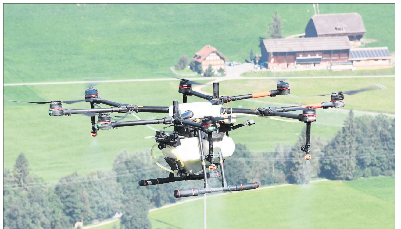
Die Drohne DJI, eigentlich ein Oktokopter, hat acht elektrisch betriebene Rotoren und wiegt, inklusive vollem Tank, 24 Kilogramm.
