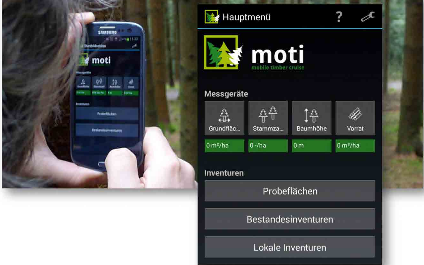
Abb. 1: Hauptdisplay des MOTI mit Messfunktion, Inventurmodi und Funktions-Parametern
