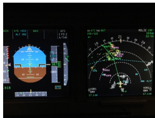
Abbildung 1: links sieht man den künstlichen Horizont und das Instrument rechts ist ein Radar
