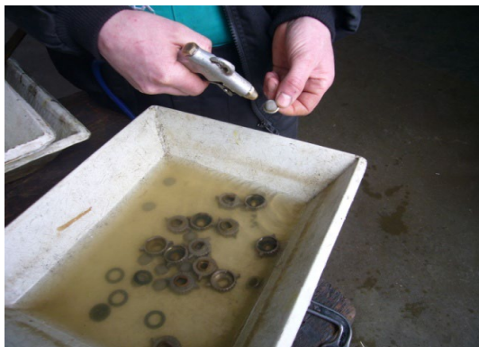
Düsenfilter in Essigwasser einlegen, evtl. mit Zahnbürste und Druckluft reinigen. Bild: A.Koch, LVLT
