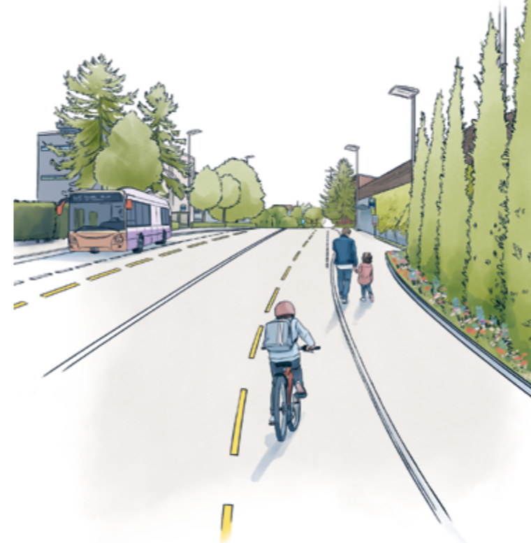
In Richtung Rothenburg sorgt ein 1,8 Meter breiter Velostreifen für mehr Sicherheit.
